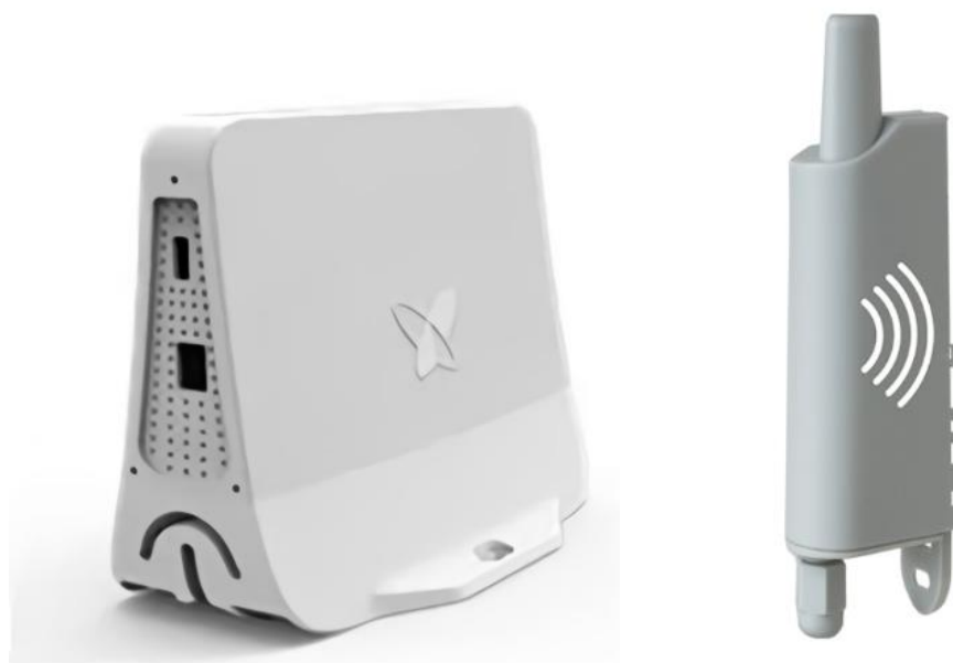
Obr. 3.13: Jednotka mikrozakladňovej stanice Sigfoxu a repeater signálu
