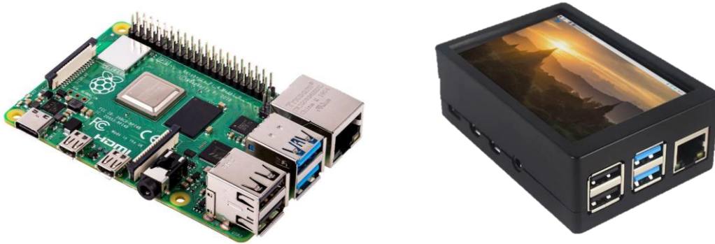
Obr. 2.1: Mikropočítač Raspberry Pi 4B samostatne a v použitej krabičke s displejom
